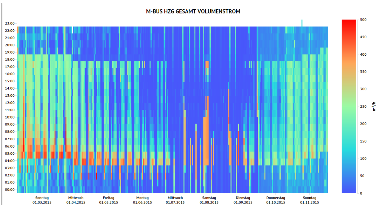
Abbildung 5: Nicht jeder Tag hat 24 Stunden: Die Zeitumstellung (Normalzeit/Sommerzeit) verursacht Probleme; hier: die nicht korrekt konfigurierte Datenerfassung zeigt eine Verschiebung um eine Stunde. Auch sichtbar: Tag mit 23 und Tag mit 25 Stunden.
